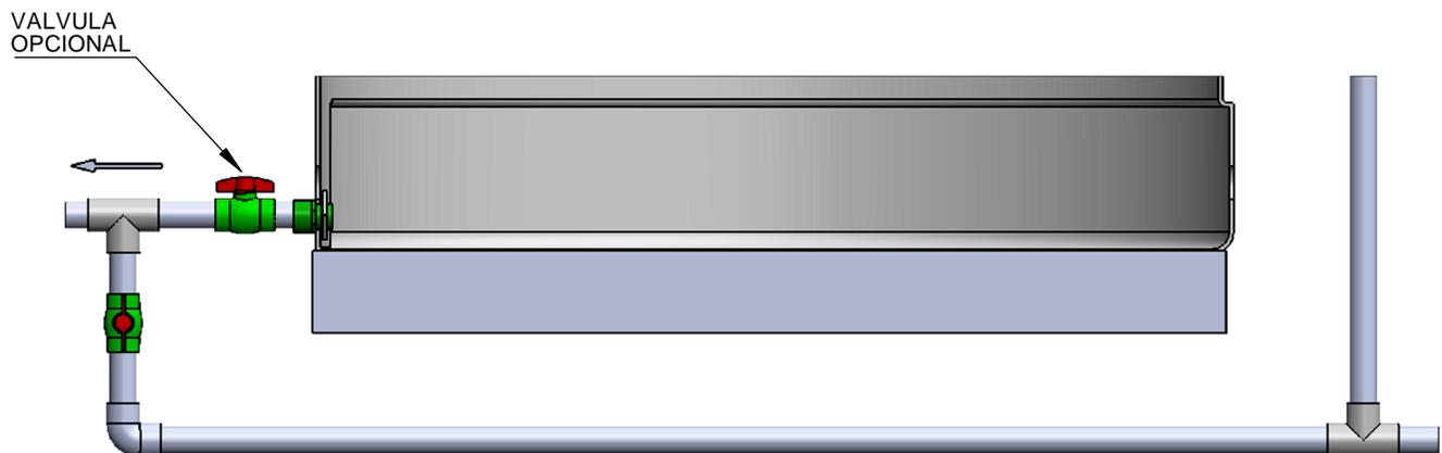
Al tener la conexión correcta puede proceder a pegar el tubo al conector del tanque. Se sugiere instalar un registro para abrir o cerrar el ingreso de agua para arreglos o mantenimientos. Se sugiere también realizar una conexión entre las tuberías de **Salida** y **Rebose** de igual manera para arreglos o mantenimientos , junto con una ventilación para evitar burbujas en el flujo, la conexión entre la salida y el rebose debe tener un registro adicional.
