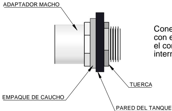
Conector macho de 1 roscado de afuera hacia adentro con el empaque de caucho puesto externamente entre el conector y la pared del tanque, la tuerca de 1+se rosca internamente para asegurar y ajustar la conexión .
