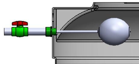
Al tener la conexión correcta puede proceder a pegar el tubo al conector del tanque. Se sugiere instalar un registro para abrir o cerrar el ingreso de agua para arreglos o mantenimientos. Si se instala flotador este deberá estar nivelado para el cierre de agua a la misma altura en la que está el orificio y conexión de **Rebose**.
