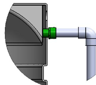
Al tener la conexión correcta puede proceder a pegar el tubo al conector del tanque.
