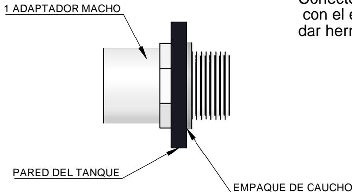
Conector macho de roscado de afuera hacia adentro, con el empaque de caucho puesto desde el interior para dar hermeticidad al roscar con su válvula flotador.
