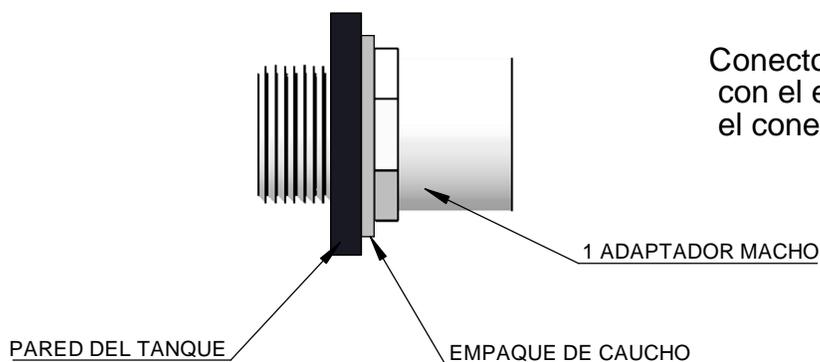
Conector macho de roscado de afuera hacia adentro con el empaque de caucho puesto externamente entre el conector y la pared del tanque.
