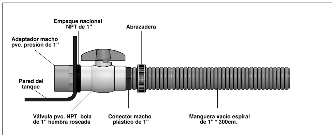
Nota: si el contenido del tanque llegase a ser corrosivo o peligroso, es mejor que no tenga orificios de entrada o salida por debajo del nivel del líquido. El cargue y descargue del líquido se debe hacer través de la tapa superior o "manhole". Es recomendable también construir piscinas de seguridad alrededor del tanque para contrarrestar posibles fugas.
